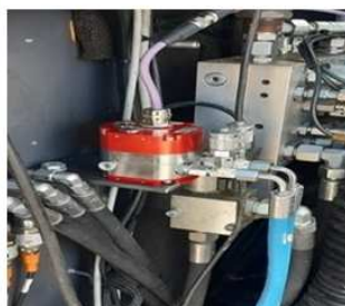
Slika 3: Primjeri ugradnje FluidInspectIR® In-line analizatora (1)
